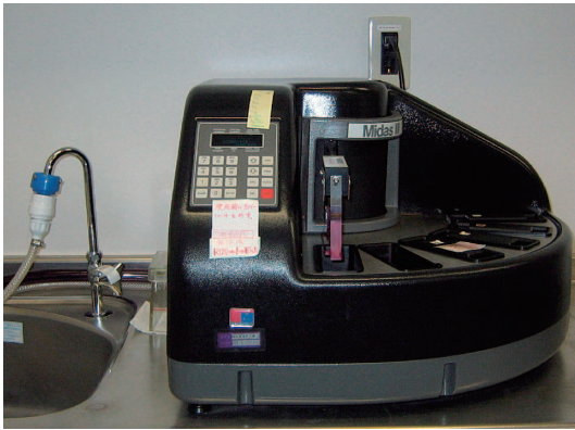
図1. グラム染色の自動染色装置 (ミダス III)
