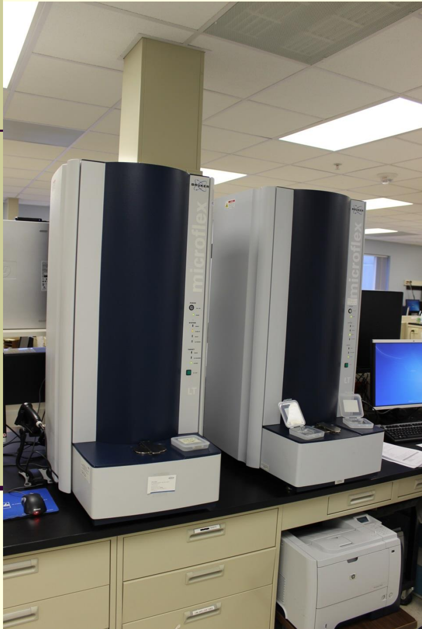
Bruker MicroFlex Biotyper™
